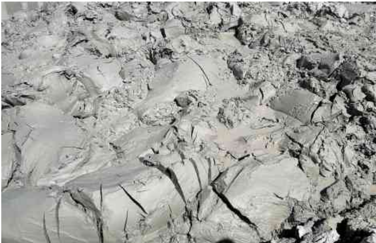
Bild 2 Seitlich gelagerter Seeton während der Bauarbeiten
