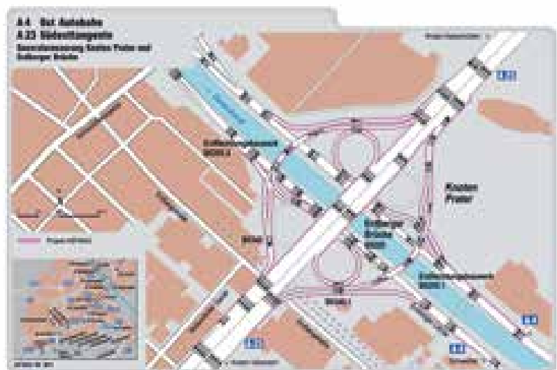
1 Verkehrsströme nach Gesamtfertigstellung © ASFINAG Baumanagement GmbH
