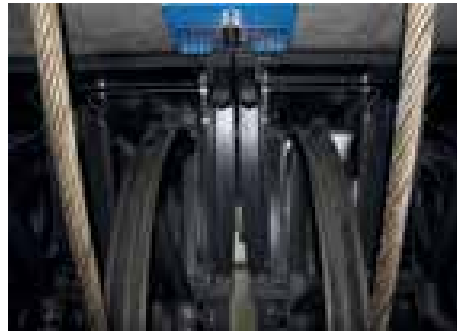
19 20 Platzverhältnisse in der Hollow Box und Schmiereinrichtung an den unteren Seilrollen © Waagner-Biro Bridge Systems AG
