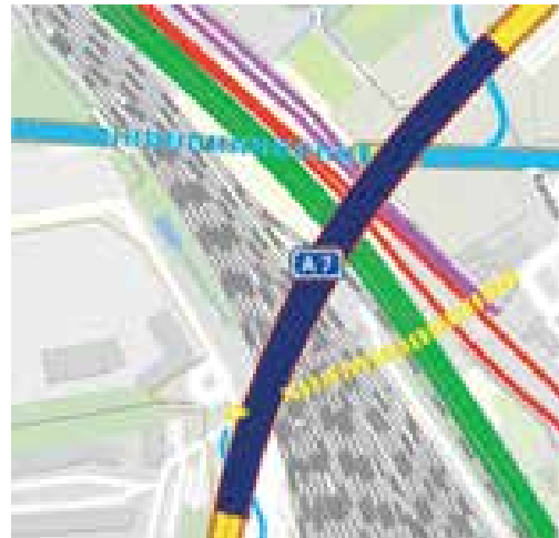
2 Kreuzung der Langenfelder Brücke mit Straßen, Gleisen und dem Fußgängertunnel © Hochtief
